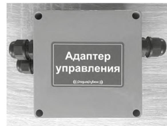
Управление системой осуществляется устройствами управления (УУ). Эти элементы также подключаются по цифровому интерфейсу RS-485 к контроллеру КПП.
