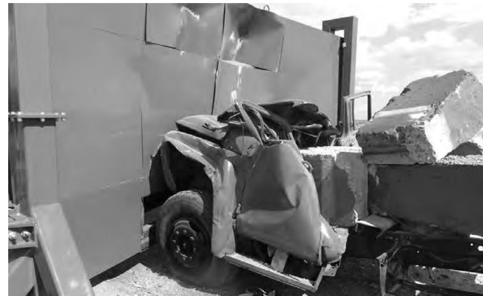
Рисунок 13. Натурные испытания противотаранных откатных ворот методом краш-теста
