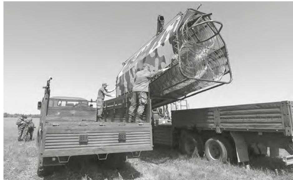
Рисунок 1. Погрузка БРЗ в кузов АТС с помощью крана-манипулятора
