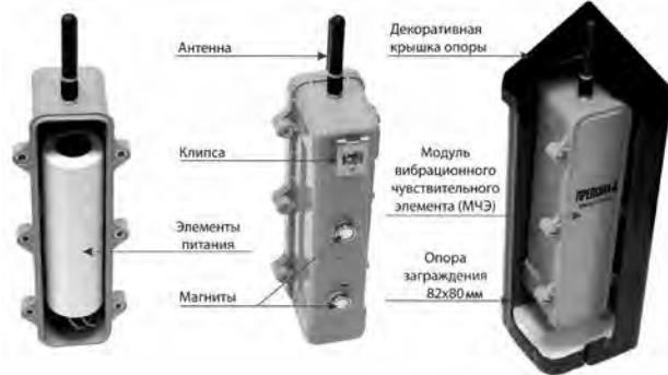
Рисунок 4. Расположение МЧЭ внутри опоры ограждения
