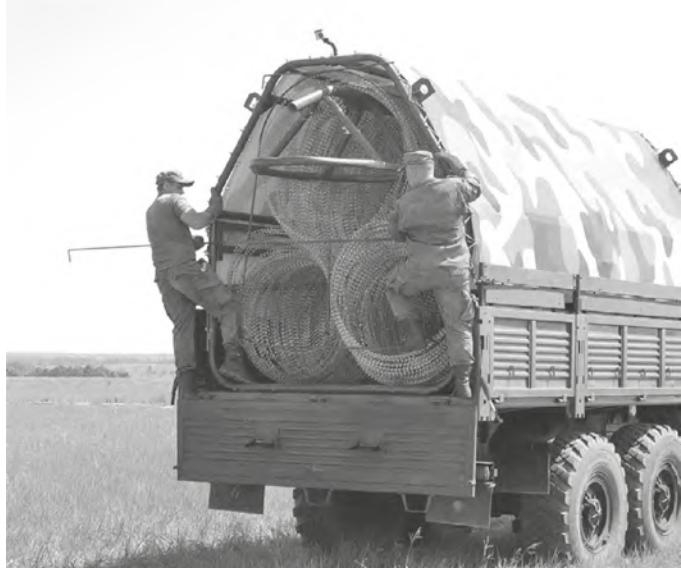
Рисунок 5. Подготовка изделия к процессу развертывания спиралей АКЛ
