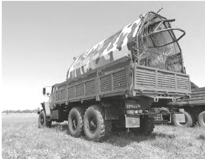
Рисунок 4. БРЗ, подготовленное для транспортировки
