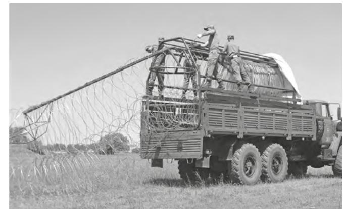
Рисунок 14. Процесс свертывания спиралей АКЛ изделия
