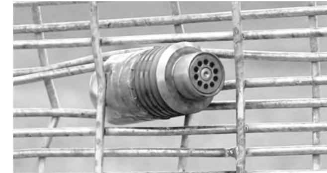
Рисунок 3. Результат попадания инертного боеприпаса в двухслойную сварную панель
