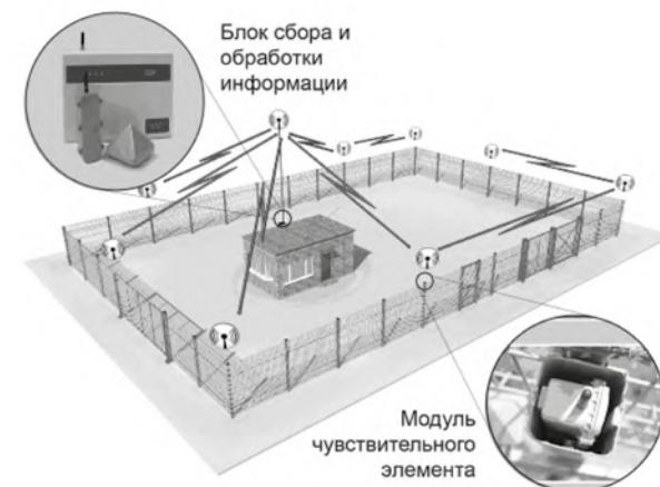
Рисунок 3. Беспроводная система охраны периметра на основе вибрационного средства обнаружения «PREPONA-A»
