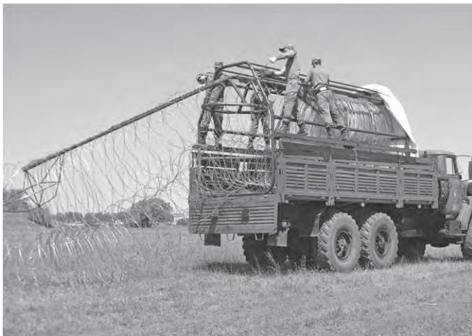
Рисунок 14. Процесс свертывания спиралей АКЛ изделия
