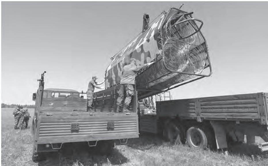
Рисунок 1. Погрузка БРЗ в кузов АТС с помощью крана-манипулятора
