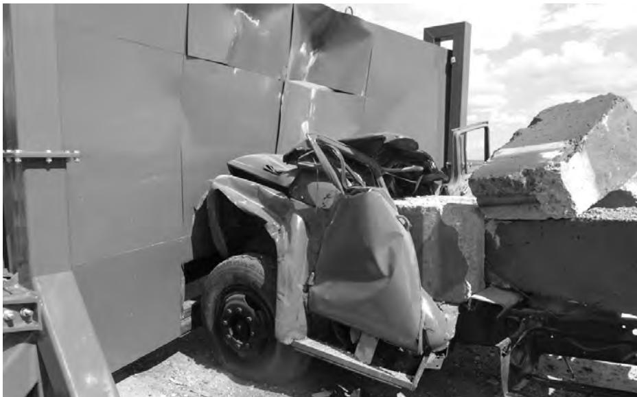
Рисунок 13. Натурные испытания противотаранных откатных ворот методом краш-теста
