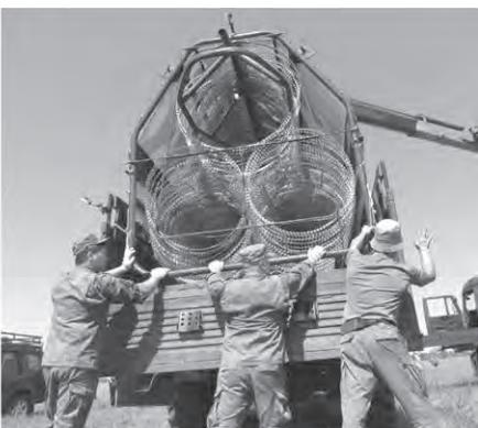
Рисунок 3. Установка изделия в кузов АТС
