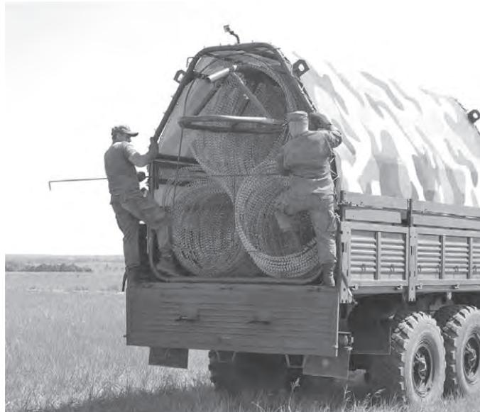
Рисунок 5. Подготовка изделия к процессу развертывания спиралей АКЛ
